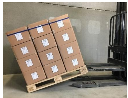
Maakt een 30° hellingshoek van de pallets mogelijk met een enkel geschikt spanband
